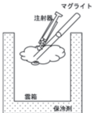
図1 雲箱を用いたダイヤモンドダスト実験。絞った光の中でぷちぷちを注射器でつぶす。
